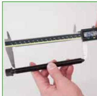
② Messen Sie die Gewindelänge bis zur Spindel Spitze. Measure the thread length to the tip of the spindle.
