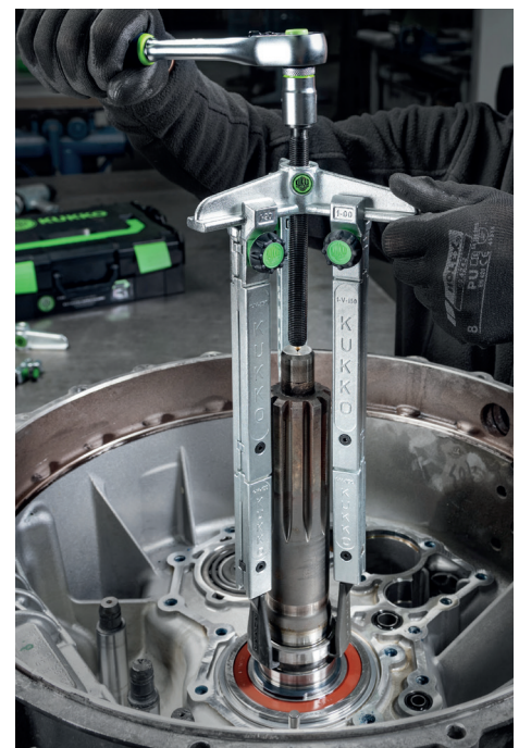
Der 30-10+S-C mit verlängerten, schmalen Abzugshaken beim Abziehen eines Kugellagers
