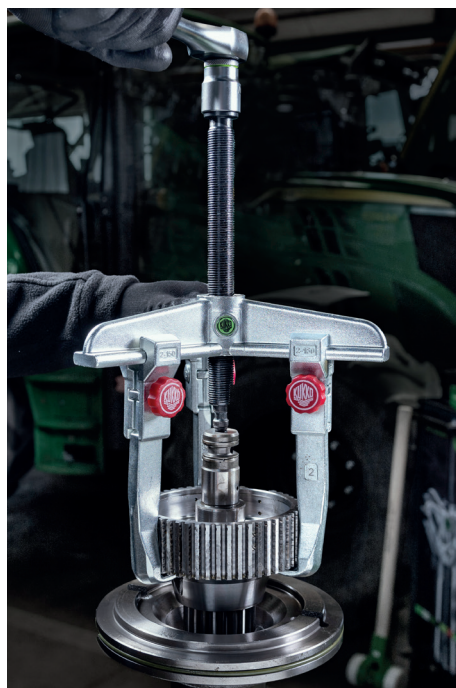
Abziehen eines Zahnrades von einer Welle mit dem 30-10+
