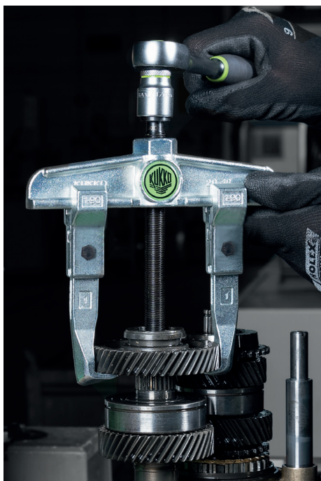
Abziehen eines Getriebezahnrades mit dem 20-10
