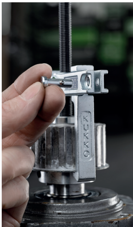
Manuell herausnehmbarer Sicherungsstift
