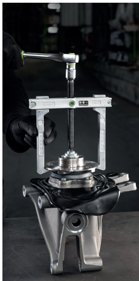
Abziehen einer Radnabe von einem Achsschenkel mit dem 110-2
