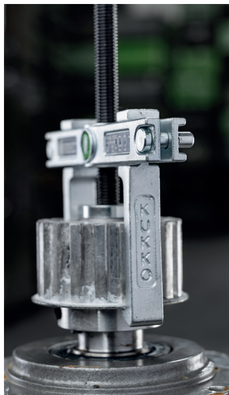
Sicherungsstift ist eingesetzt worden
