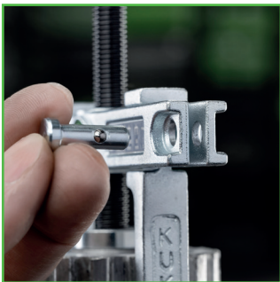
Sicherungsstift wird in den 110-02 eingesetzt
