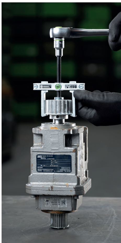
Abziehen einer Riemenscheibe von einem Maschine- triebe mit dem 110-02
