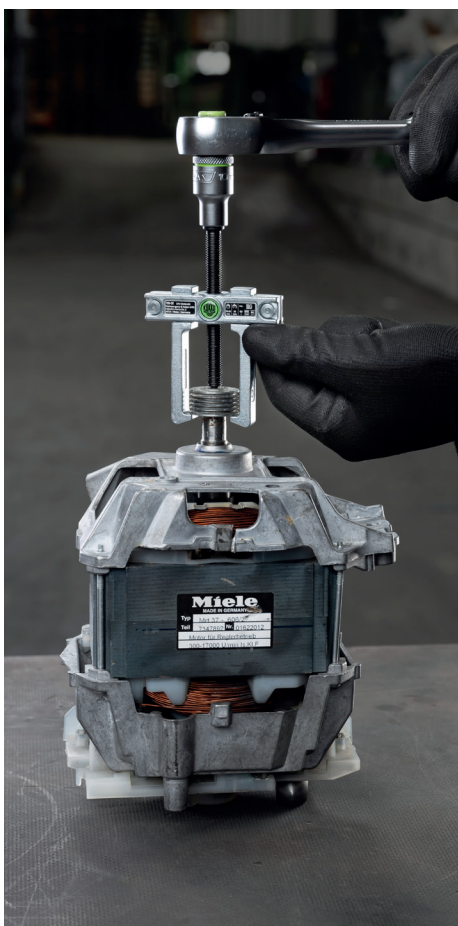
Abziehen einer Riemenscheibe von einem Waschma- schinenmotor mit dem 110-01
