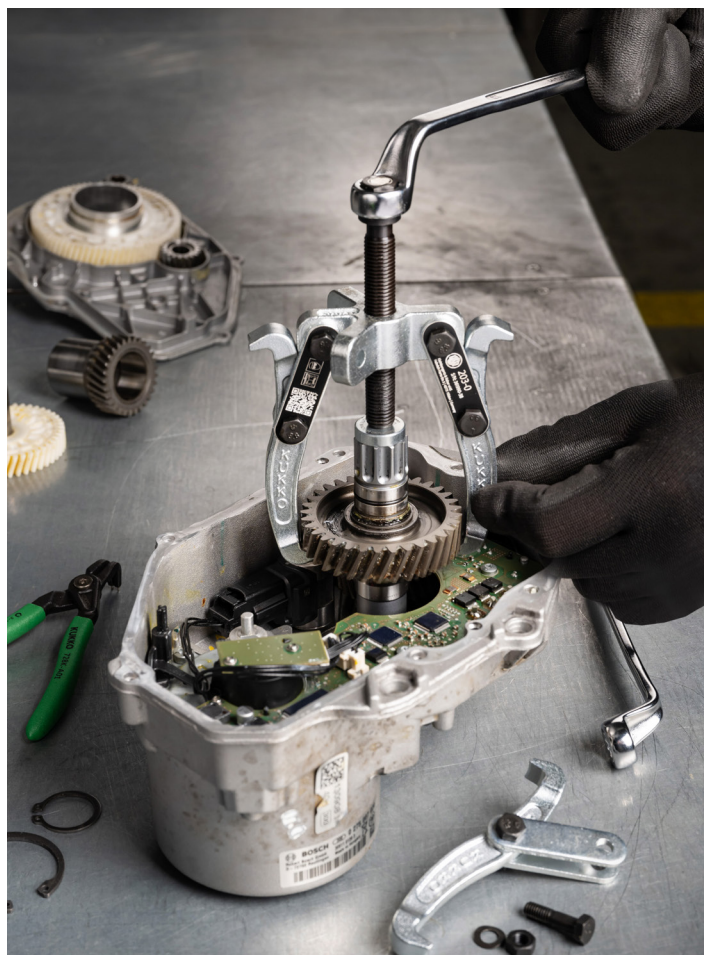
Dank der Kombi-Traverse kann der 203-0 nach kurzem Umbau auch für 2-armiges Abziehen verwendet werden.
