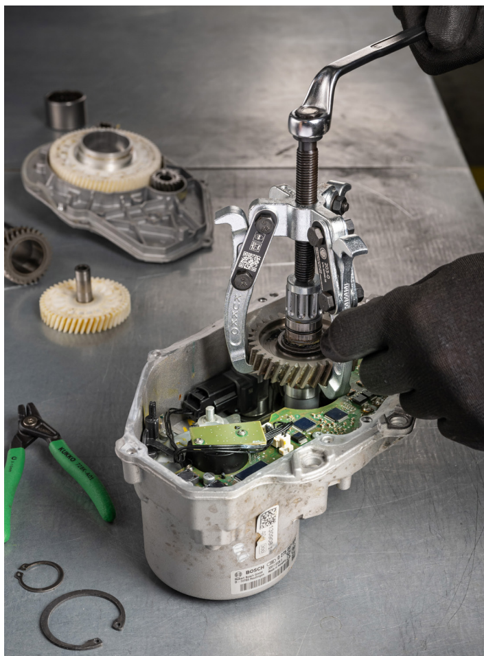
3-armiger Laschenabzieher mit Kombi-Traverse beim Ausbau eines Zahnrades aus einem Elektromotor
