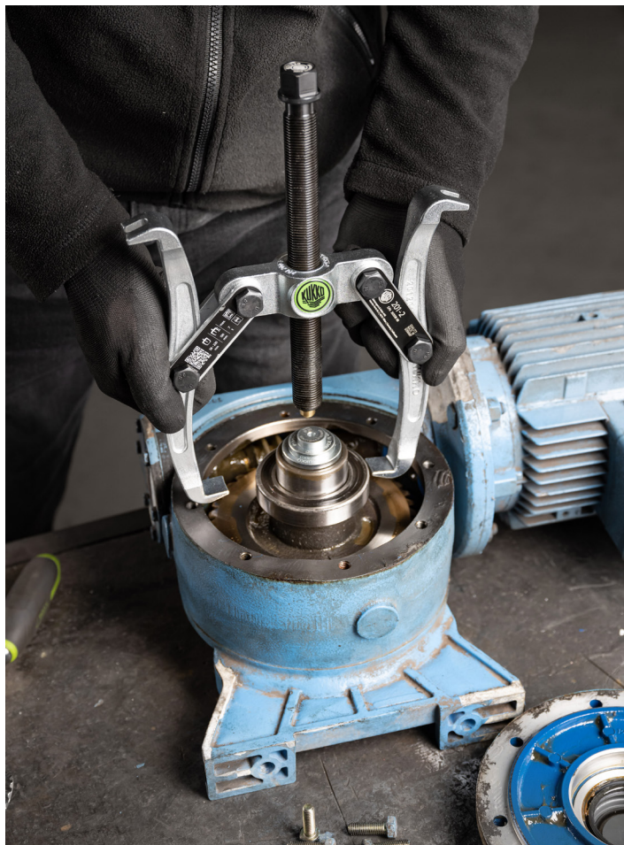
Die oszillierenden Abziehschenkel der Baureihen 201, 202 und 203 lassen sich perfekt am abzuziehenden Teil ansetzen
