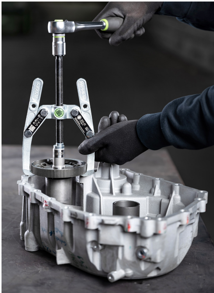
Ausbau eines Getriebezahnrades mit dem 205-01
