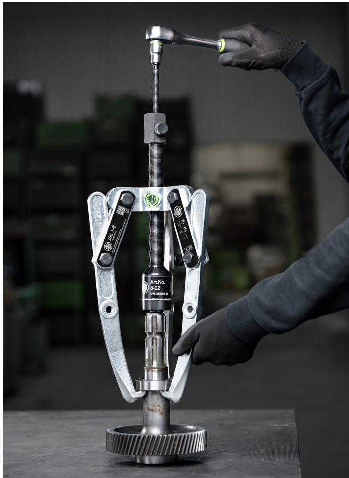
Demontage eines Kugellagers von einer Zahnradwelle mit dem hydraulischen Laschenabzieher 206-1-B
