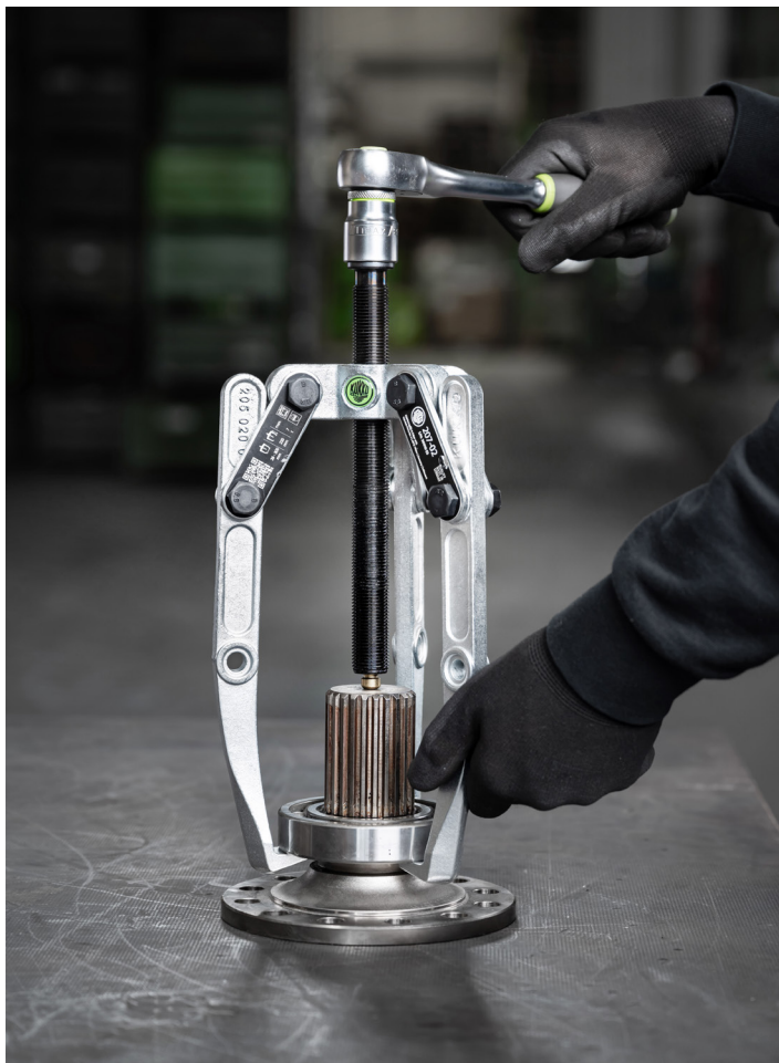
Abziehen eines Kugellagers mit dem schweren Laschenabzieher 207-02
