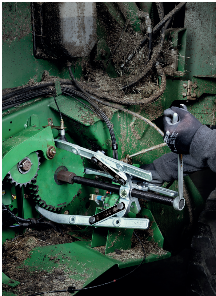
Abziehen eines Zahnrades mit dem schweren Laschenabzieher 207-2
