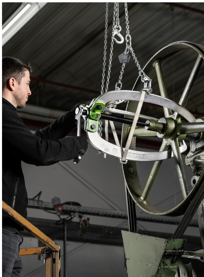
Ein zusätzlicher Spanngurt fixiert die Abziehschenkel
