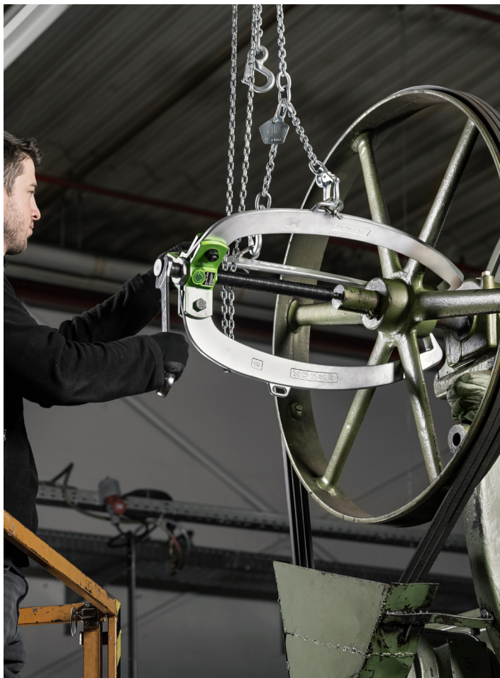
Abziehen einer Riemenscheibe mit dem 45-8 mit mechanischer Spindel. Zur Arretierung und Halterung ist der Abzieher mit dem URANUS verbunden.
