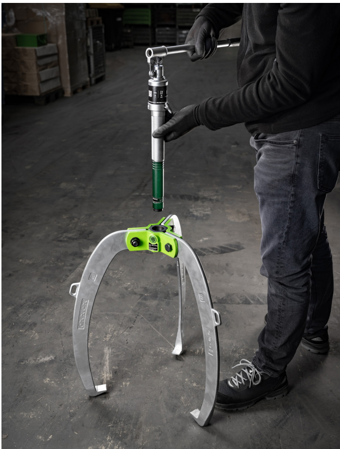
Einsetzen der fetthydraulischen Spindel
