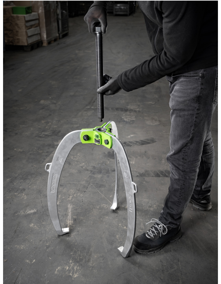
Entfernen der mechanischen Spindel
