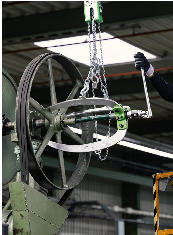
Abziehen einer Riemenscheibe mit dem 45-8 mit hydraulischer Spindel
