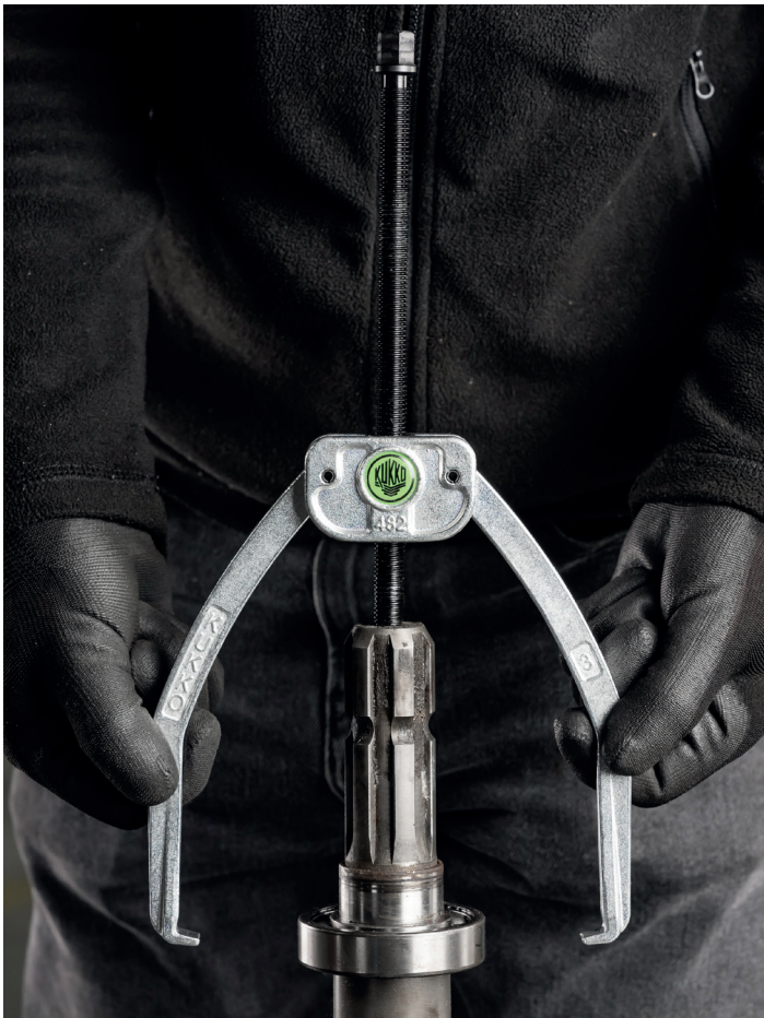
Ansetzen der Abziehschenkel an das zu demontierende Bauteil
