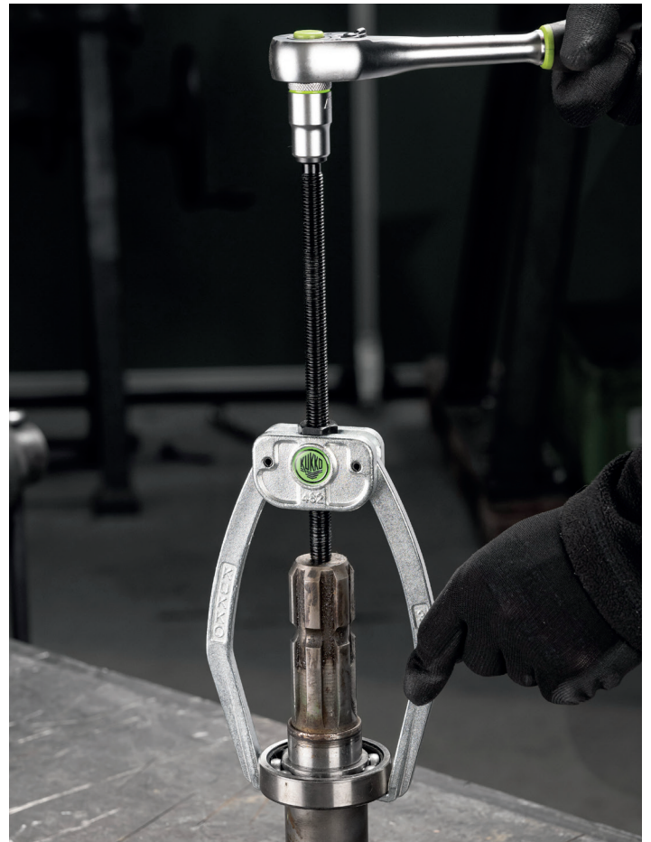
Demontage eines Kugellagers von einem Getrieberad
