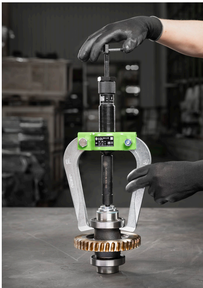
Abziehen eines Kugellagers vom Getrieberad
