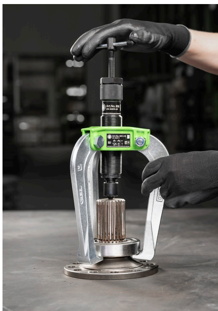
Demontage eines Kugellagers von Antriebsflansch
