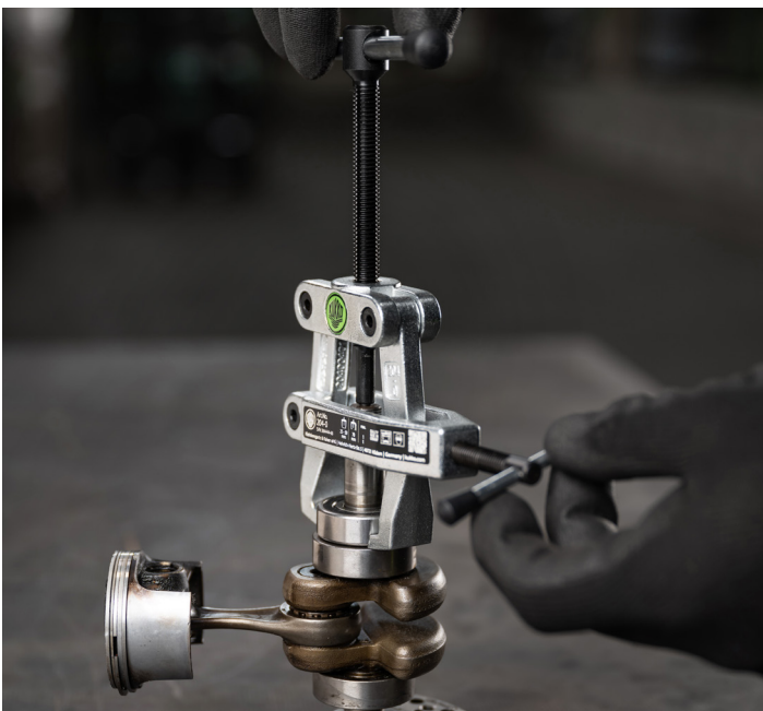
Abziehen eines Kugellagers von einer Kurbelwelle einer Kettensäge mit dem 204-0
