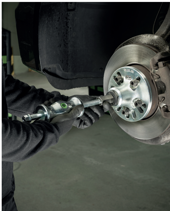
Der Radnabenabzieher 229-1-1 mit Gleithammer beim Ausziehen festsitzender Radnaben an einem PKW
