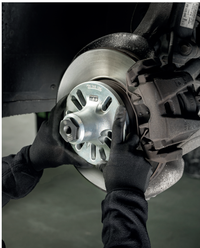
Anbringen des Abziehers an die Radnabe
