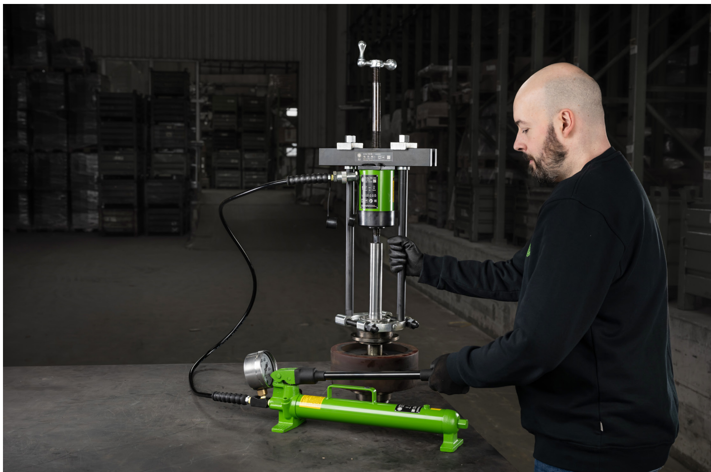
Trennabziehen an einem Transportrad mit der hydraulischen Abziehvorrchtung Y28-180 in Kombination mit der Trennvorrichtung Y-215-2
