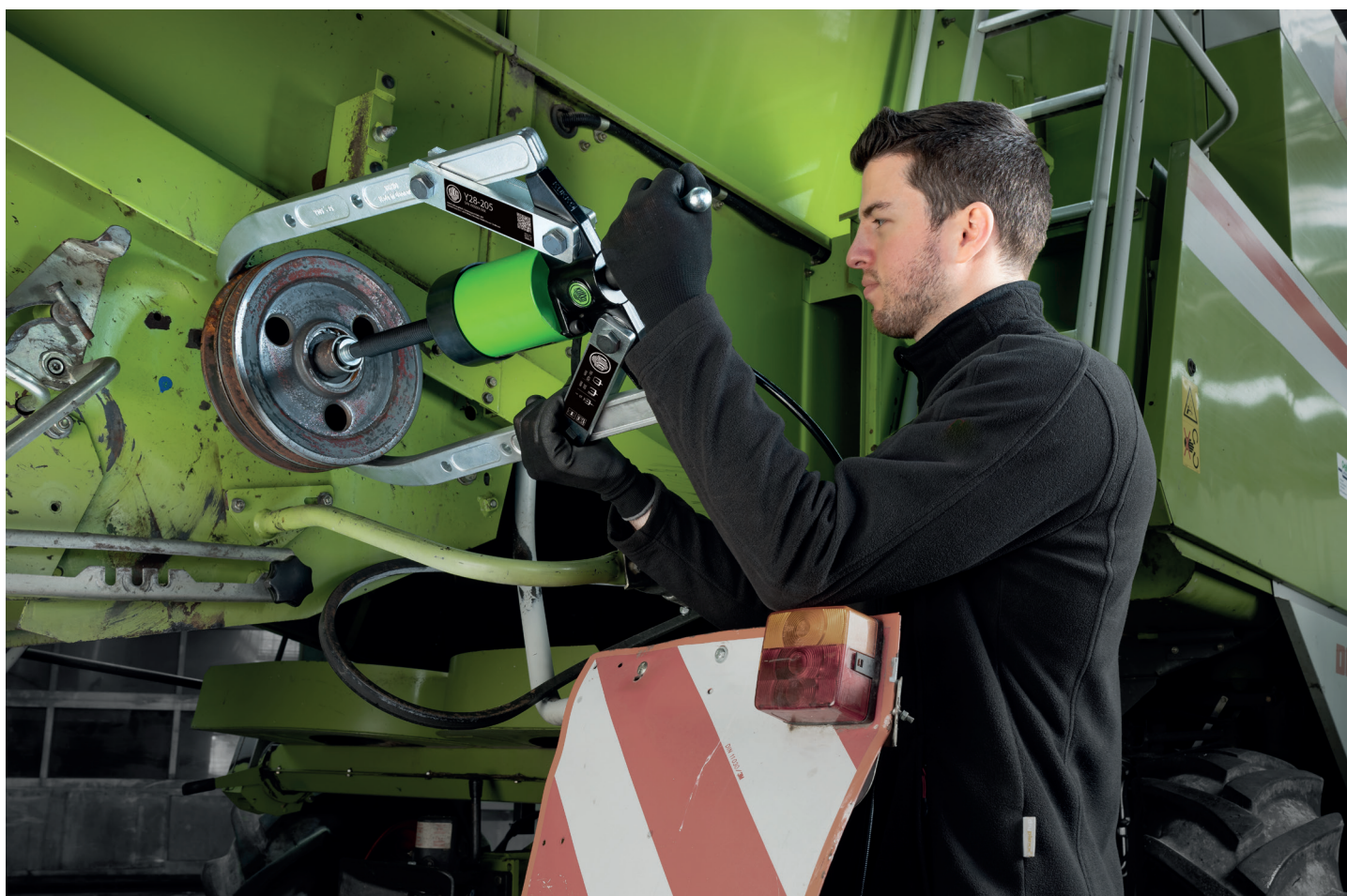
Außenabziehen einer Riemenscheibe an einem Mähdrescher mit dem hydraulischen Abzieher Y28-205
