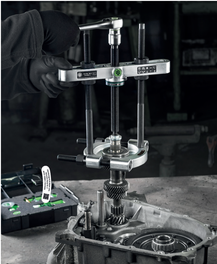
Abziehen eines Lagers von einer Getriebewelle
