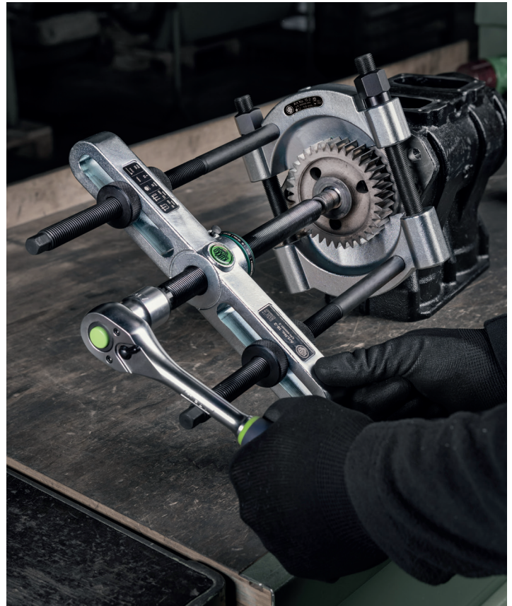
Abziehen eines Getriebezahnrades
