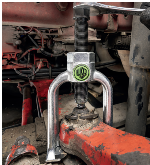
Der Kugelgelenkabzieher 128-60 beim Ausdrücken eines Spurstangenkopfes an einer Spurstange in einer Werkstatt
