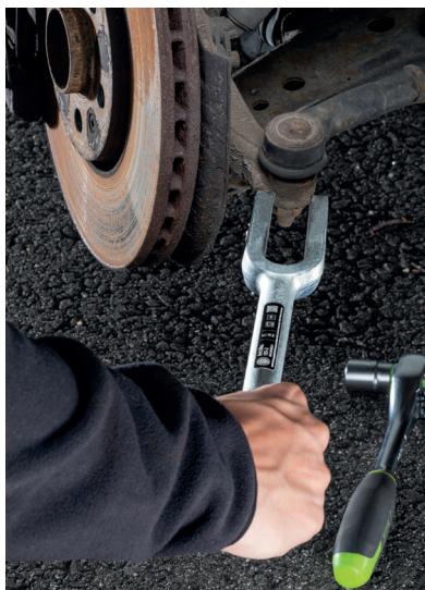
Trennen eines Querlenkers von der Radaufhängung
