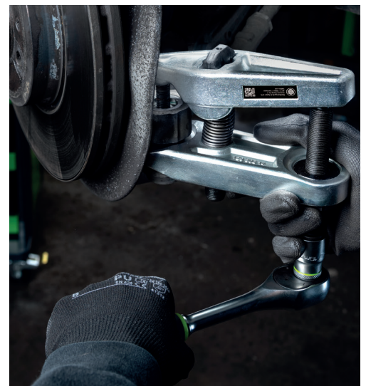
Der Kugelgelenk-Ausdrücker 129-3 beim Ausdrücken eines Spurstangenkopfes in einer Werkstatt
