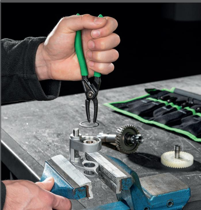
Ausziehen eines Sicherungsrings
