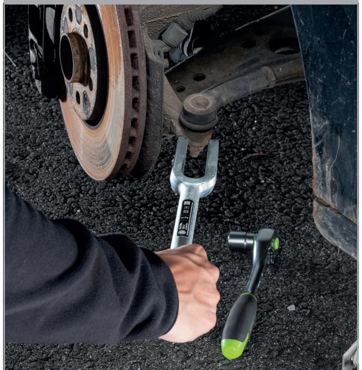
Trennen eines Querlenkers von der Radaufhängung
