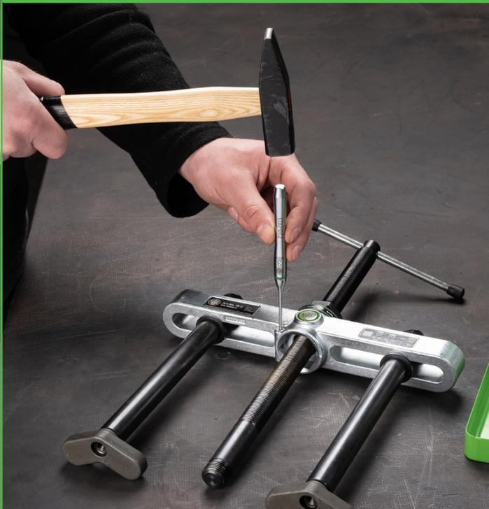
Austreiben eines Sicherungssplints mit einem Splintentreiber
