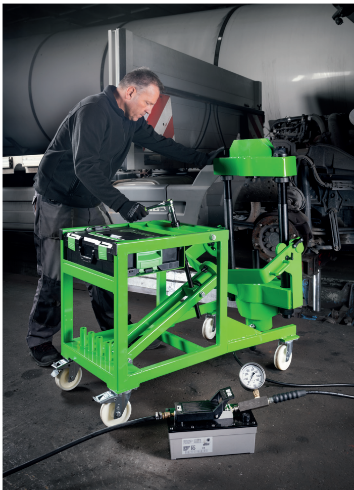
Die Hydraulische Achsschenkelbolzenpresse „AXLE“ Y-AP-75 wird mit einer Ratsche eingestellt
