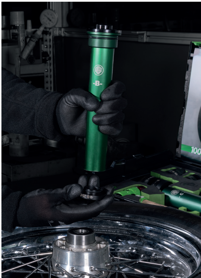
Einsetzen des passenden Schlagrings in das Schlagrohr bei Verwendung eines K-71 Satzes
