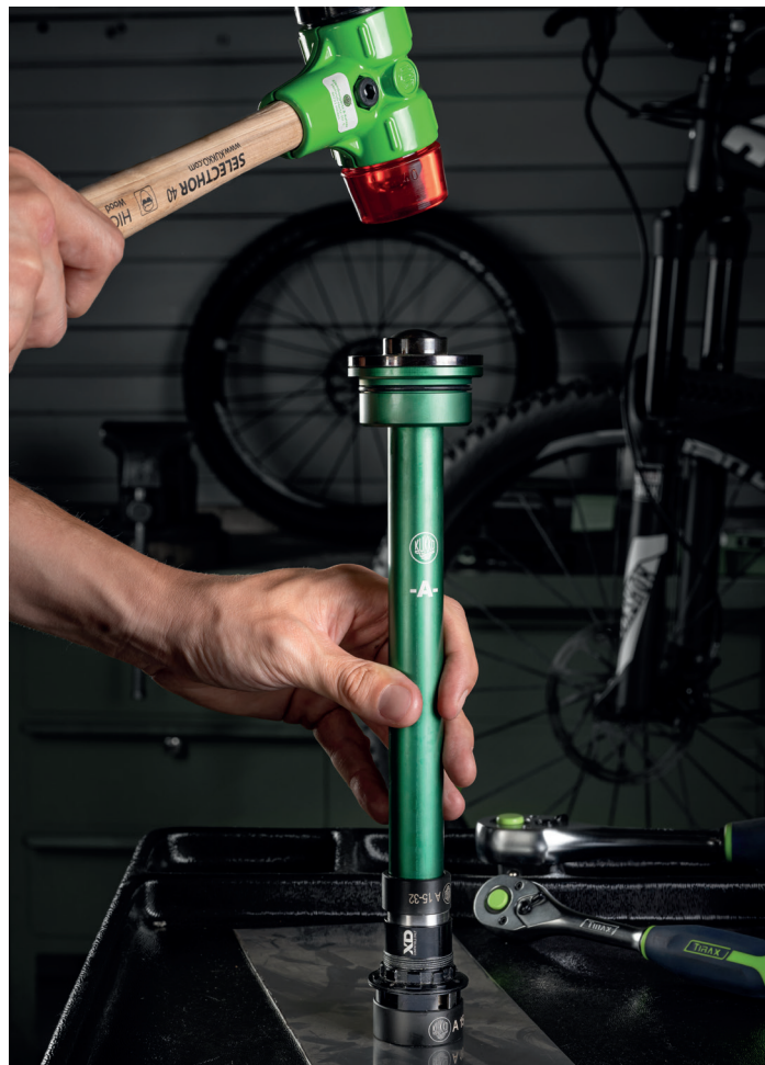
Einpressen eines Lagers unter Einsatz eines K-71
