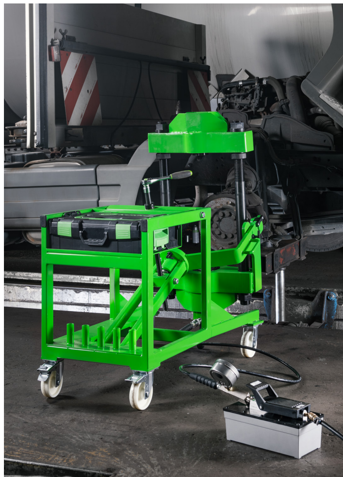
Die Hydraulische Achsschenkelbolzenpresse „AXLE“ Y-AP-75 ist bereit für den Einsatz an einem LKW
