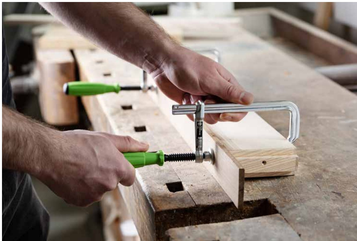
Ein Werkstück aus Holz wird mit zwei Ganzstahl-Schraubzwingen VIRIDIS der Baureihe 469P festgehalten
