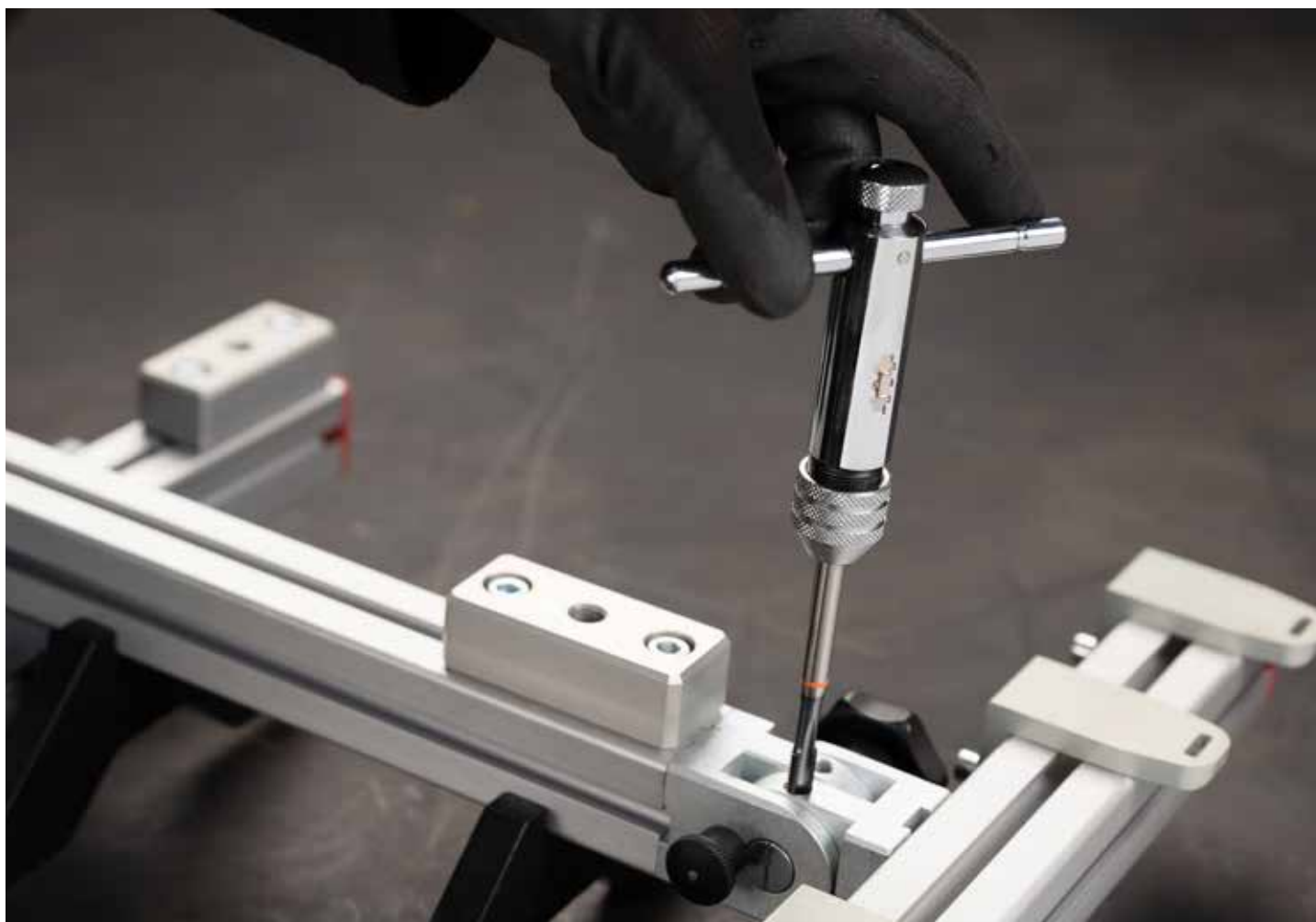
Der in dem Werkzeug- und Bohrhalter 280-100 befestigte Bohrer wird zum Bearbeiten eines Werkstücks genutzt
