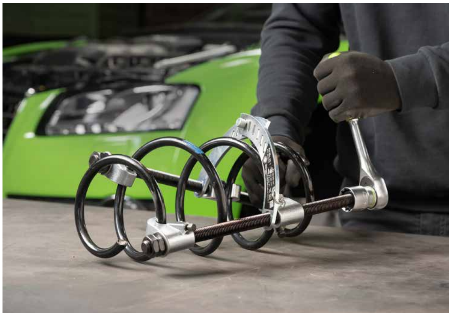
Der Federspanner "Universal" 65-1 beim Spannen einer Schraubfeder
