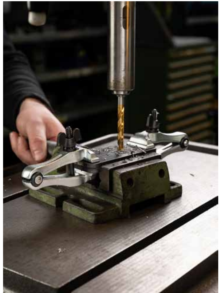
Zwei Handfeilkloben 101-100 beim Spannen mehrerer Werkstücke für Bohrarbeiten
