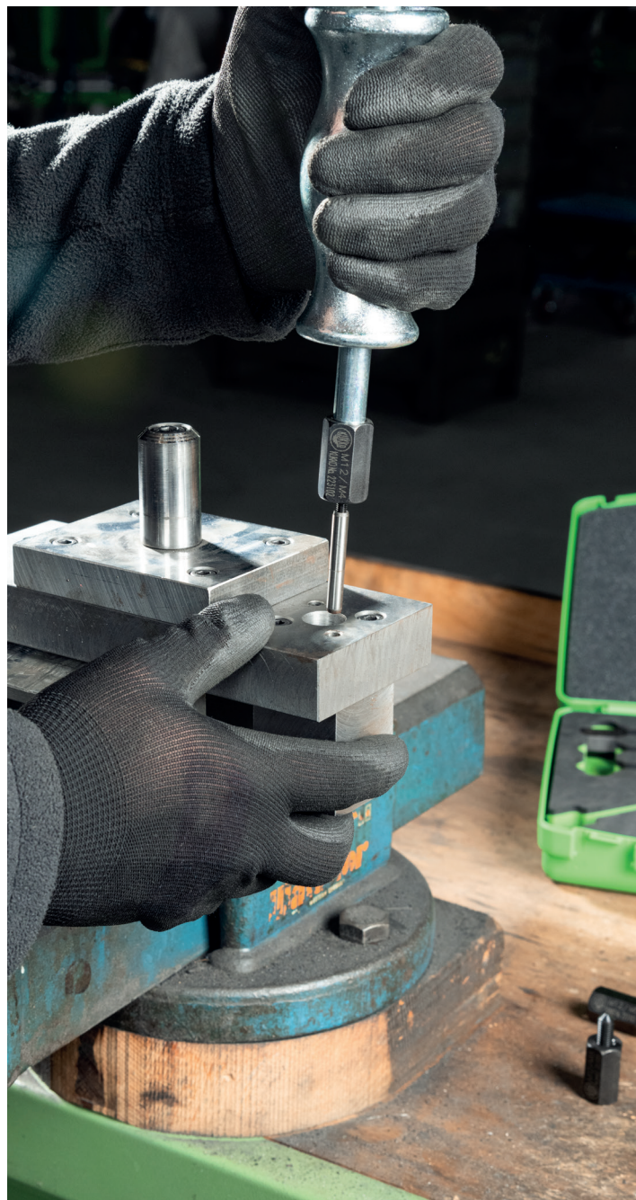
Innenausziehen eines Passstiftes per Gleithammer mit Gewintheadapter
