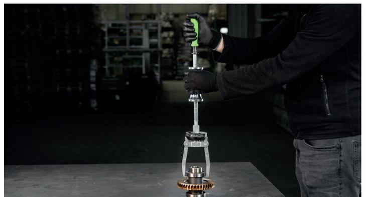
Abziehen eines Kugellagers mit einem Gleithammer und dem Abzieher 220-2
