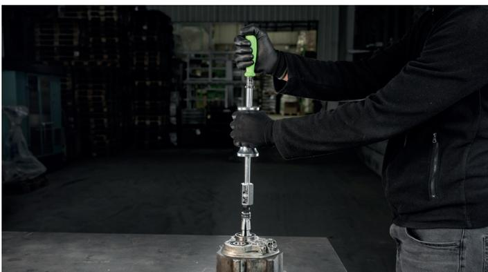
Ausziehen eines Kugellagers mit Gleithammer und einem Innenauszieher der Serie 21
