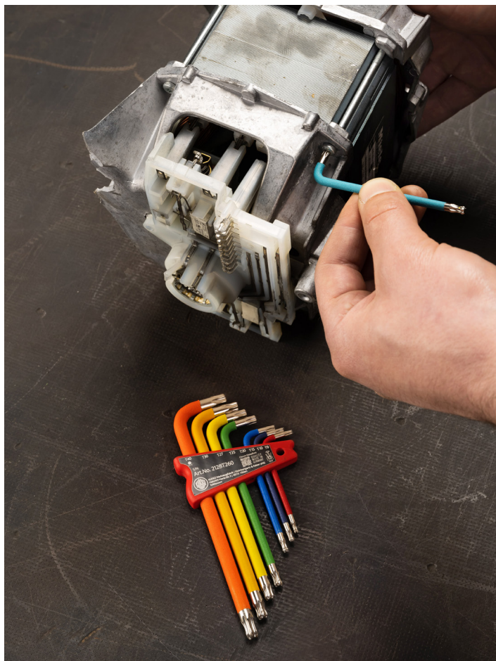
Lösen einer Torxschraube an einem Elektromotor mit einem Winkelschraubendreher aus der Serie 212
