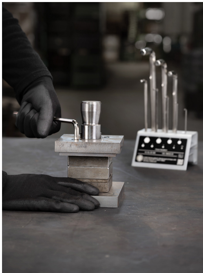
Die Winkelschraubendreher aus dem Verkaufs- und Werkstattständer ISO 2936 bei der Demontage eines Stanzwerkzeugs
