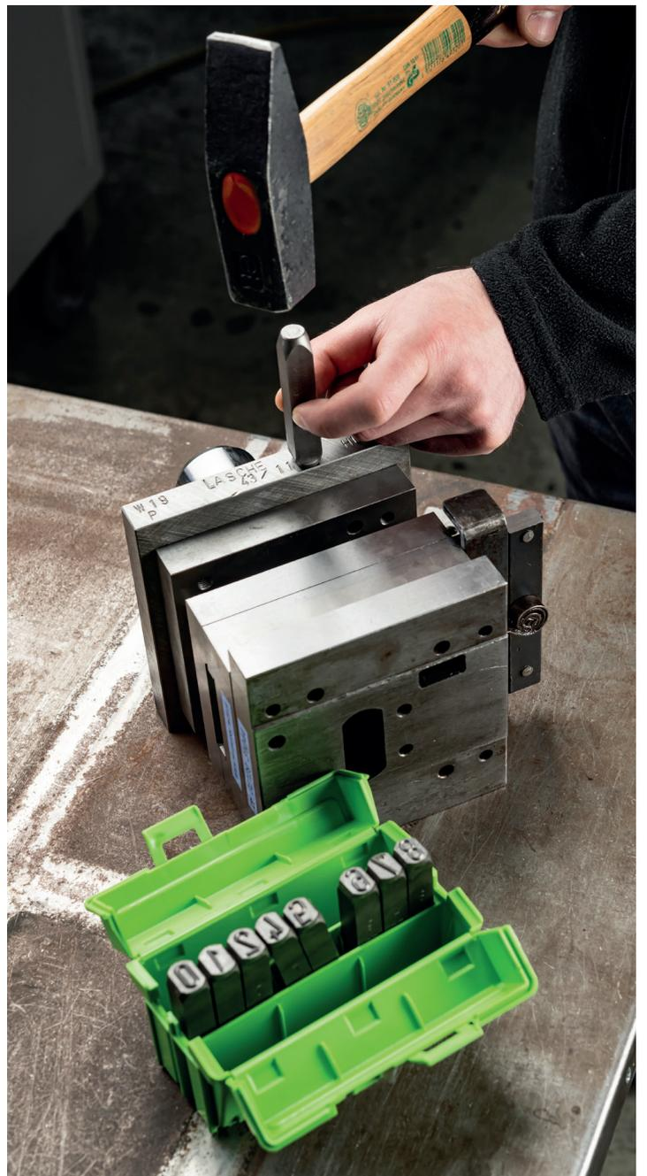
Markieren eines Stanzwerkzeugs mit Schlagzahlen der Baureihe 328
