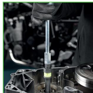
Verbindungsmutter M12/M10 zur Verbindung von Gleithammer und Innenauszieher
