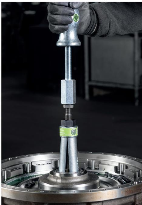
Ausziehen eines Kugellagers mittels Gleithammer, Verbindungsmutter und Gewindeadapter
