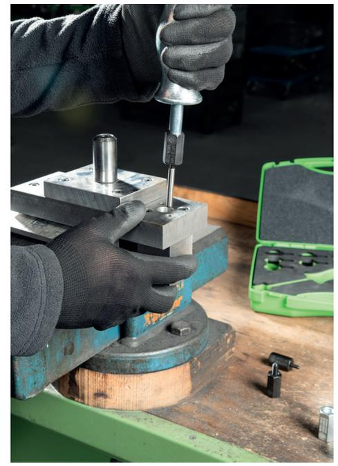
Ausziehen eines Passstiftes mittels Gleithammer und Gewindeadapter
