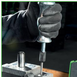
Innenausziehen eines Passstiftes per Gleithammer mit dem Gewindeadapter M12/M4
