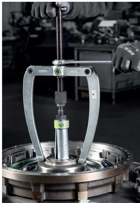
Ausziehen eines Kugellagers mittels Gegenstütze und Gewindeadapter
