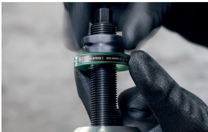
Die Power Nut wird auf die Spindel geschraubt
