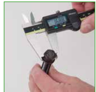
d Messen Sie den Sechskant des Spindelkopfes.
